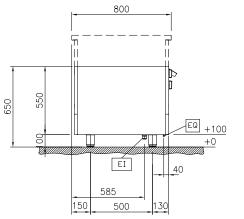
Electrical inlet (power) Equipotential screw EQ
